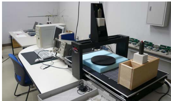
電磁波測定EMCスキャナー
